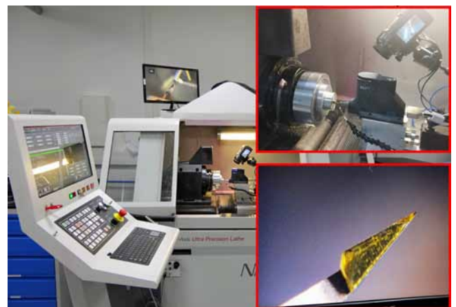
Ursprüngliches Geschäftsmodell von son-x war der Einsatz von Diamantwerkzeugen auf Werkzeughaltern für das Ultrapräzisionsdrehen. Die Halter schwingen dabei im Bereich von Ultraschall-Frequenzen (Foto: Klaus Vollrath)
