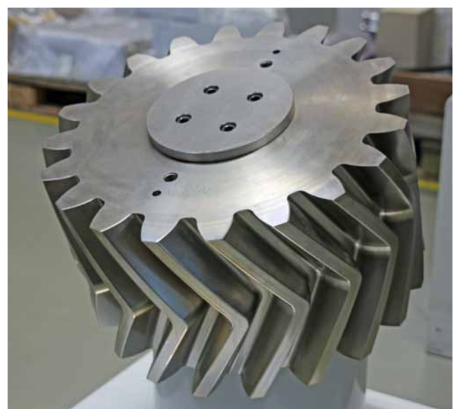
Dieses pfeilverzahnnte Stirnrad mit 450 mm Ø und 250 mm Zahnbreite aus 16MnCr5 mit einer Härte von 60-62 HRC wurde auf einer Röders RXU 1001 DSH in 18 h und 45 min einsatzfertig gefräst (Foto: Klaus Vollrath)
