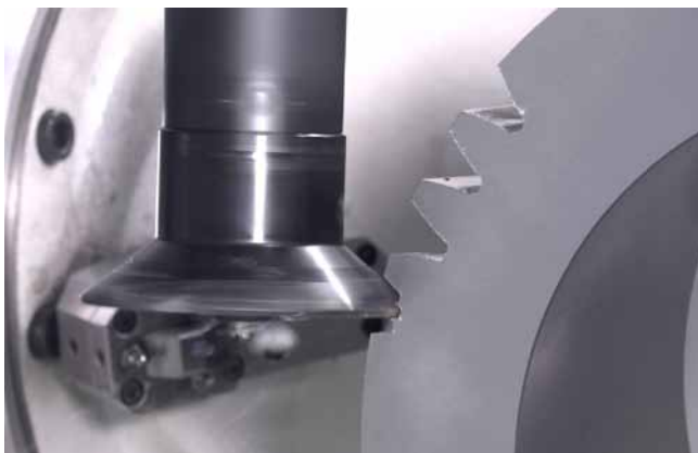
Das Schruppen der Zahnkonturen in den gehärteten Zahnkranz erfolgt mit einem konischen Invo-Milling-Scheibenfräser (Foto: Röders)
