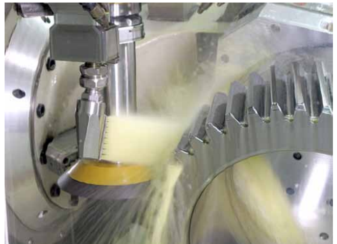
Konisches Schleifrad mit im Paket integrierter Schleiföldüse für das präzise Finishen der Zahnflanken (Foto: Röders)
