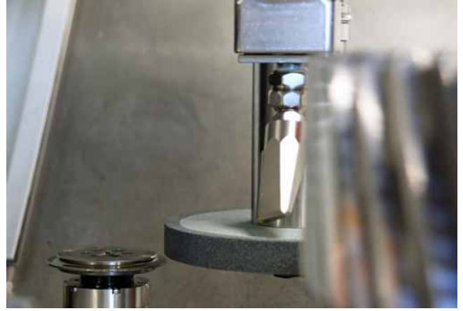
Ein diamantbesetztes Abrichtrad sorgt für die präzise Formgebung der Schleifwerkzeuge (Foto: Klaus Vollrath)
