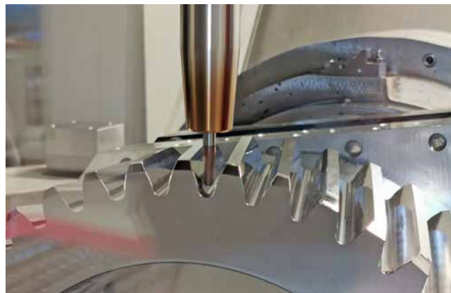
Für die Herstellung der Zahnfußrücknahme kommen normale Schaftfräser aus dem Standard-Werkzeugmagazin zum Einsatz (Foto: Klaus Vollrath)
