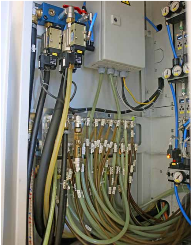
Die Temperierung aller wesentlichen Komponenten der Röders-Bearbeitungszentren ist Voraussetzung für eine hochgenaue Bearbeitung (Foto: Klaus Vollrath)
