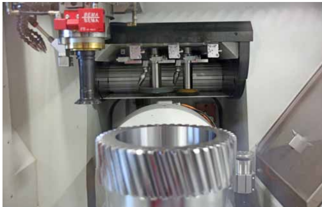
Die großformatigen Werkzeuge für die Zahnradherstellung sind in einem separaten Magazin unterhalb des Portals untergebracht (Foto: Klaus Vollrath)
