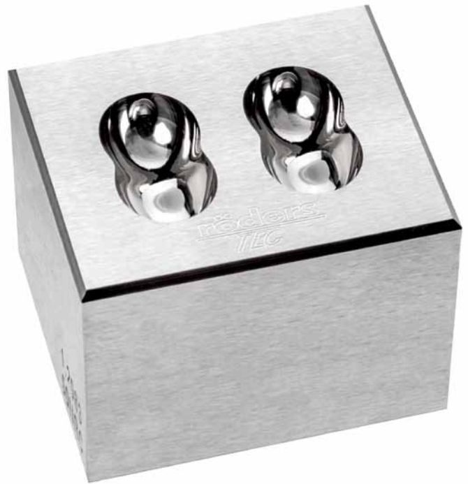
Optische Oberfläche mit R_a = 15 nm direkt auf der Maschine hergestellt, Gesamtbearbeitungszeit pro Kavität (ca. 18 mm x 10 mm) einschließlich Schruppen weniger als 2 Stunden
